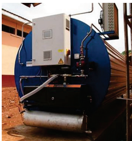
Le modèle V-Basic 14-50 de la compagnie allemande EBERL, choisi pour le séchage sous vide de notre bois d'exception.
